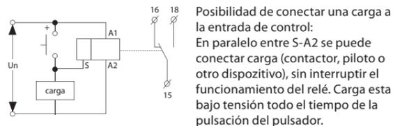
Posibilidad de conectar una carga a la entrada de control: En paralelo entre S-A2 se puede conectar carga (contactor, piloto o otro dispositivo), sin interrumpir el funcionamiento del relé. Carga esta bajo tensión todo el tiempo de la pulsación del pulsador.
