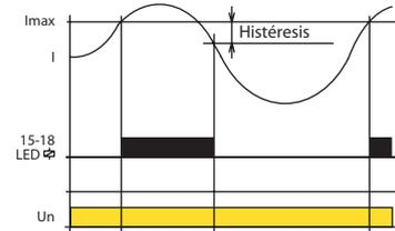
El relé de control PRI-32 se utiliza para supervisar el nivel de corriente en los circuitos de AC de 1 fase. Ajuste suave de corriente de diferencia predetermina este relé para aplicaciones donde es necesario indicar el corriente que atraviesa el relé, también se puede usar como relé preferido. El relé de salida está apagado en el estado de normalidad. Relé conmuta con el exceso de nivel de corriente ajustado. La ventaja de este relé es una fuente de alimentación universal.
